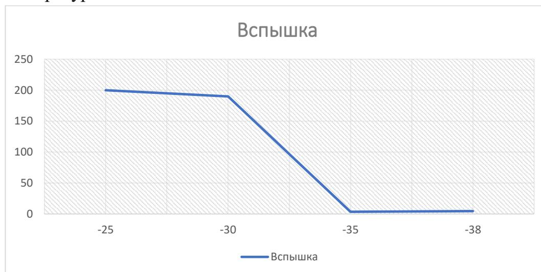
Рис.3 – Соотношение температуры вспышки в открытом тигле на температуры застывание исследуемого масло.
